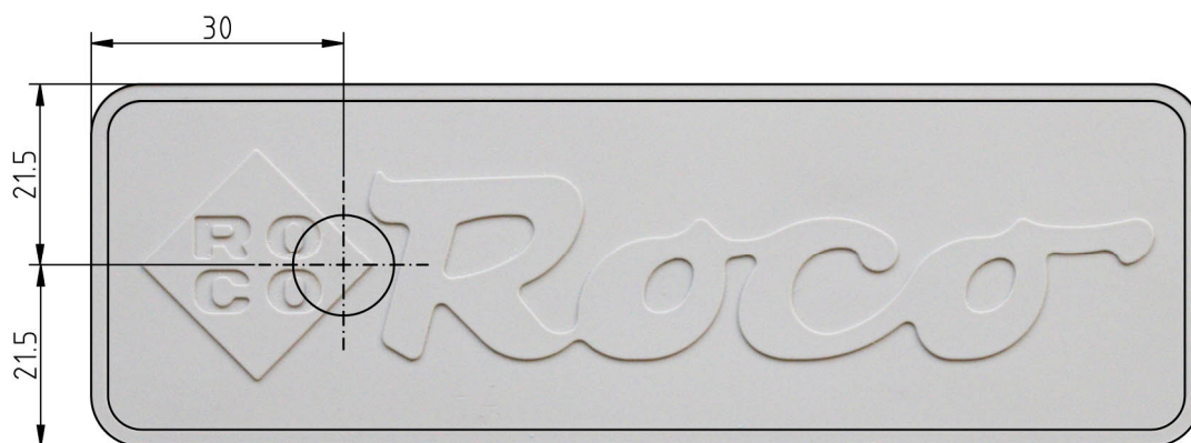
Abbildung 8: Position für die Öffnung für den Magnethalter
