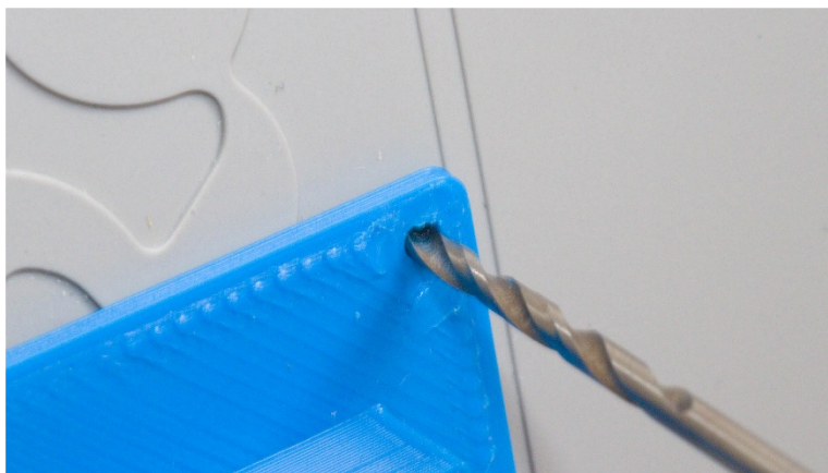
Abbildung 11: Bohren von Löchern für das Sensormodul
